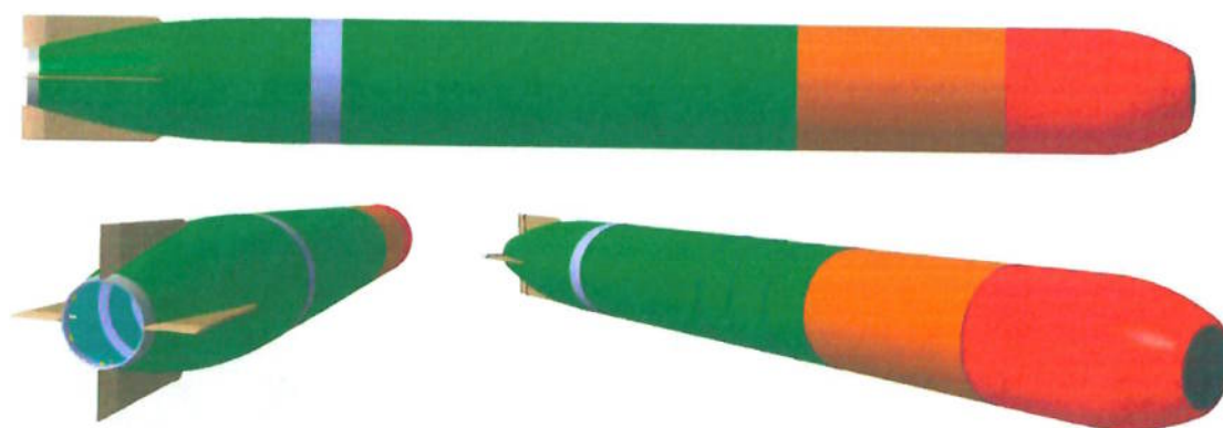
Figura 10-4 – Configuração completa do TP01 com as aletas fixas e os lemes direcionais.
