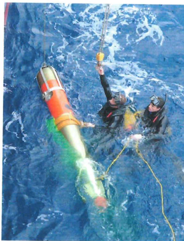
Figura 3-1 – Recolhimento de um torpedo leve Mk 46 de exercício após corrida.
